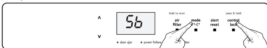
La unidad se mantiene en modo Sabbath después de la recuperación tras un corte de energía. Se debe desactivar usando los botones ubicados en el panel de control.
